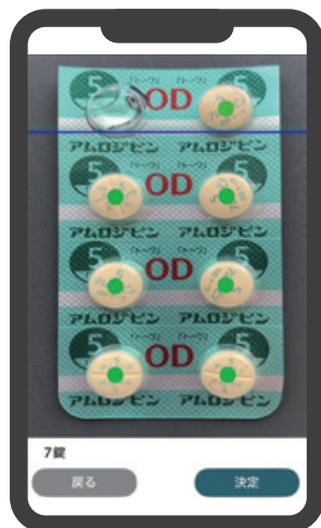
AIによる「錠数自動カウント機能」では、取り出し済みの穴(緑の点がない)はカウントしない
